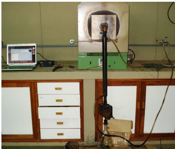
**Figura 1** – Forno elétrico adaptado com condensador resfriado à água e frasco coletor de materiais voláteis condensáveis, juntamente com o regulador de temperatura informatizado.
