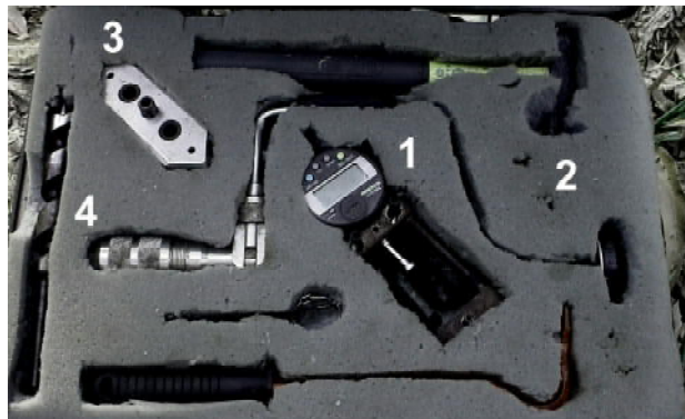
Figura 1 – Detalhes dos instrumentos utilizados para medição da Deformação Residual Longitudinal (DRL), composto pelo extensômetro (1), pinos de fixação (2), gabarito de fixação dos pinos (45,0 mm de afastamento) (3) e arco de pua com broca de 20,0 mm (4).
