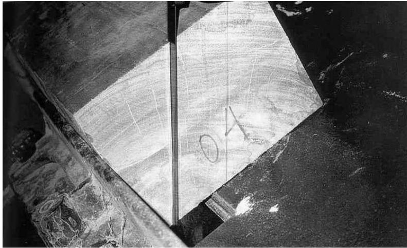
**Figura 3.** Detalhe da etapa do preparo dos corpos-de-prova. Evidencia-se a preocupação com a correta definição dos eixos principais de elasticidade do torete, para a retirada do corpo-de-prova.
