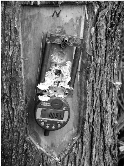
**Figura 1** – Aparelho do “CIRAD-Forêt – Growth Strain Gauge”, usado para a medição da deformação residual longitudinal (DRL).
