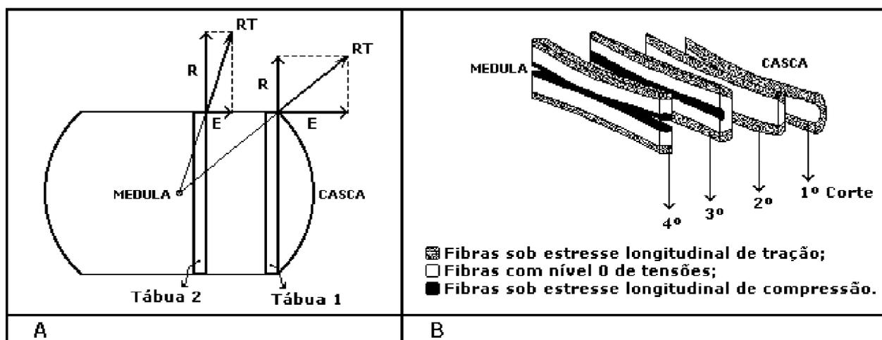
**Figura 1** – Esquema das forças responsáveis pela deformação de tábuas (A) e comportamento de defeitos (rachaduras e empenamentos) em tábuas retiradas no sentido medula à casca (B), adaptados de Santos (2002) e Touza (2001).
