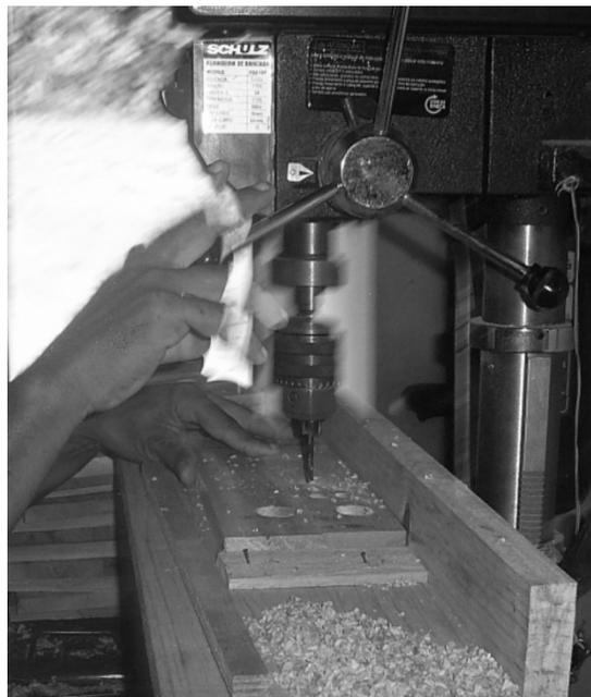
**Figura 4** – Operação de furação para cavilha dos corpos-de-prova.
